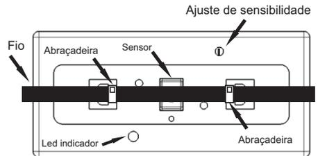
Figura 3. Esquema de montagem do ID-01X.
